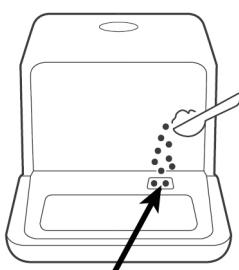
Urządzenie wymaga mniej detergentu niż urządzenie komercyjne. Zazwyczaj jedna łyżka stołowa detergentu wystarcza dla wsadu płukania przy normalnym zabrudzeniu.
