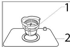
Das Filtersystem verhindert, dass größere Mengen an Speiseresten oder Fremdkörpern in das Spülsystem gelangen.
