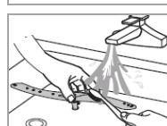
Dýzy a ložiská striekacieho ramena môžu blokovať kotolný kameň a nečistoty z oplachovacej vody. Výstupné dýzy striekacieho ramena pravidelne kontrolujte, či nie sú upchané.
