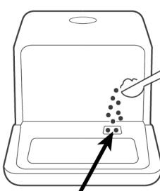
Het apparaat heeft minder vaatwasmiddel nodig in vergelijking met commerciële apparaten. Gebruik over het algemeen een soeplepel vaatwasmiddel voor een spoelbeurt van normaal bevuild vaatwerk.
