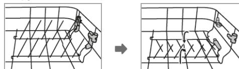
Voor een betere rangschikking van groter vaatwerk kunnen de kopje-/bordhouders worden dichtgeklapt. Til de houder lichtjes op en klap ze naar beneden
