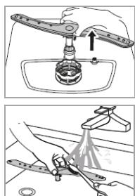
Le calcaire et des impuretés peuvent obstruer les jets et s'infiltrent dans les roulements du bras de cyclage. Contrôlez les jets du bras régulièrement et retirez toute obstruction.
