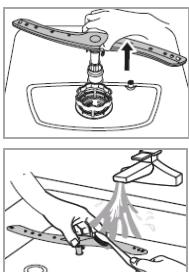
Kalk und Verunreinigungen aus dem Spülwasser können Düsen und Lagerungen des Sprüharms blockieren. Kontrollieren Sie die Austrittsdüsen des Sprüharms regelmäßig auf Verstopfungen.
