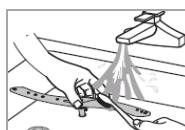
Vápník a nečistoty z vody na oplachování mohou upcat trysky a ložiska v rozprašovacím rameni. Výstupy trysek rozprašovacího ramena kontrolujte pravidelně kvůli upcání.
