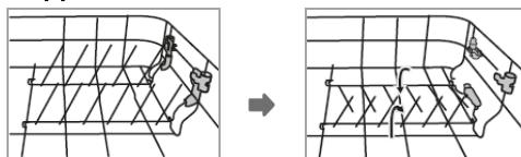
Le support à tasses/à assiettes peut être replié pour permettre la disposition de plats encombrants. Soulevez légèrement le support et repliez-le.
