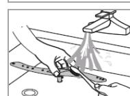
Kamień i zanieczyszczenia z wody zmywającej mogą blokować dysze i łożyska ramienia spryskiwacza. Regularnie sprawdzaj dysze wylotowe ramienia spryskiwacza pod względem zatorów.
