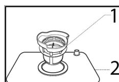
Le système de filtrage permet d'éviter que de grandes quantités d'aliments ou que d'autres objets ne pénètrent dans la pompe.
